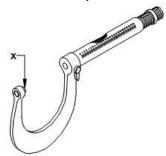
A: Anvil | निहाई B: Frame | ढांचा C: Spindle | धुरा D: Thimble | नोक
