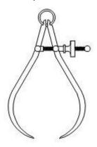
A: Inside caliper | कैलीपर के अंदर
